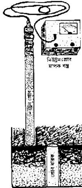
চিত্র ৫১ : নিউট্রন প্রোব যন্ত্র দ্বারা মৃত্তিকা আর্দ্রতা নির্ধারণ
